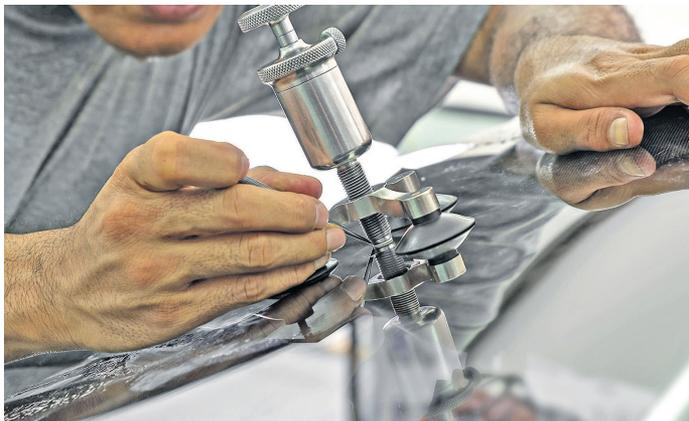
*Kleine Schäden in der Frontscheibe lassen sich reparieren, sofern sie sich nicht im Sichtfeld des Fahrers befinden und eine bestimmte Größe nicht überschreiten.*
