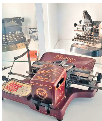
Rote Mignon, Zeigerschreibmaschine mit Typenzylinder, AEG, Berlin 1905
